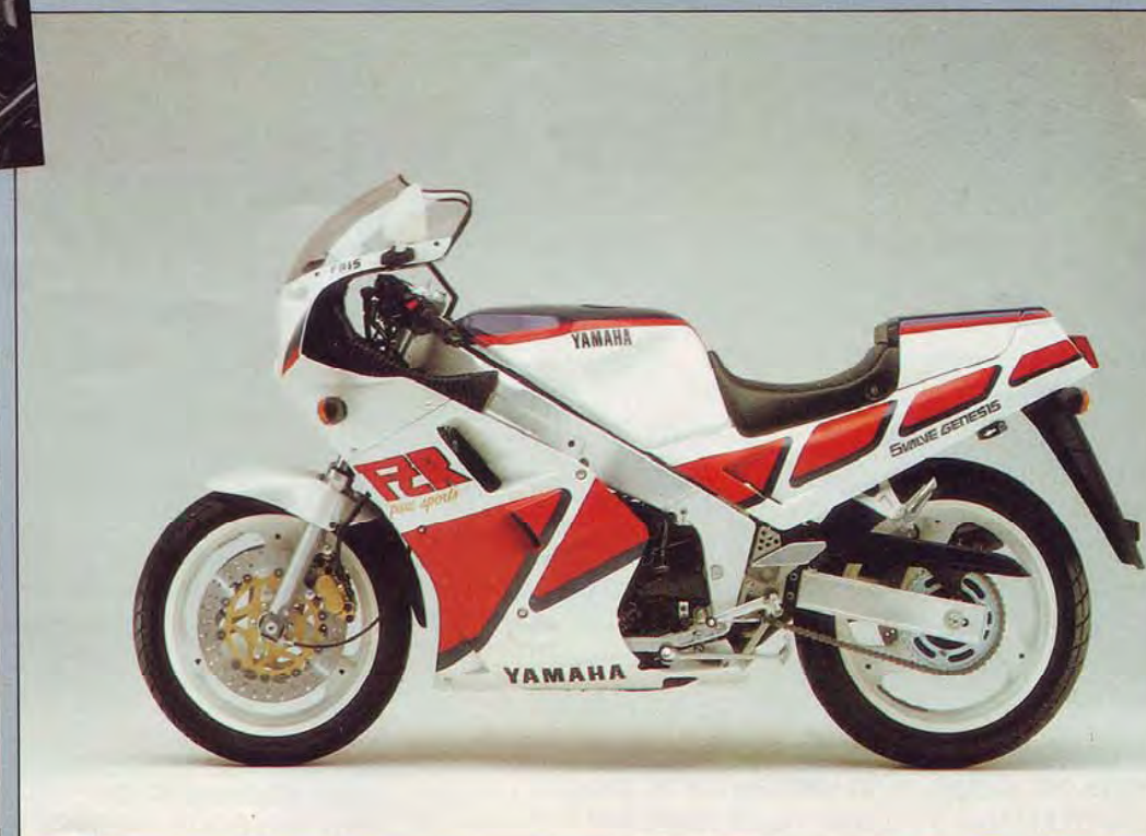
De FZR1000 brengt 204 kg op de schaal en is goed voor 135 pk
